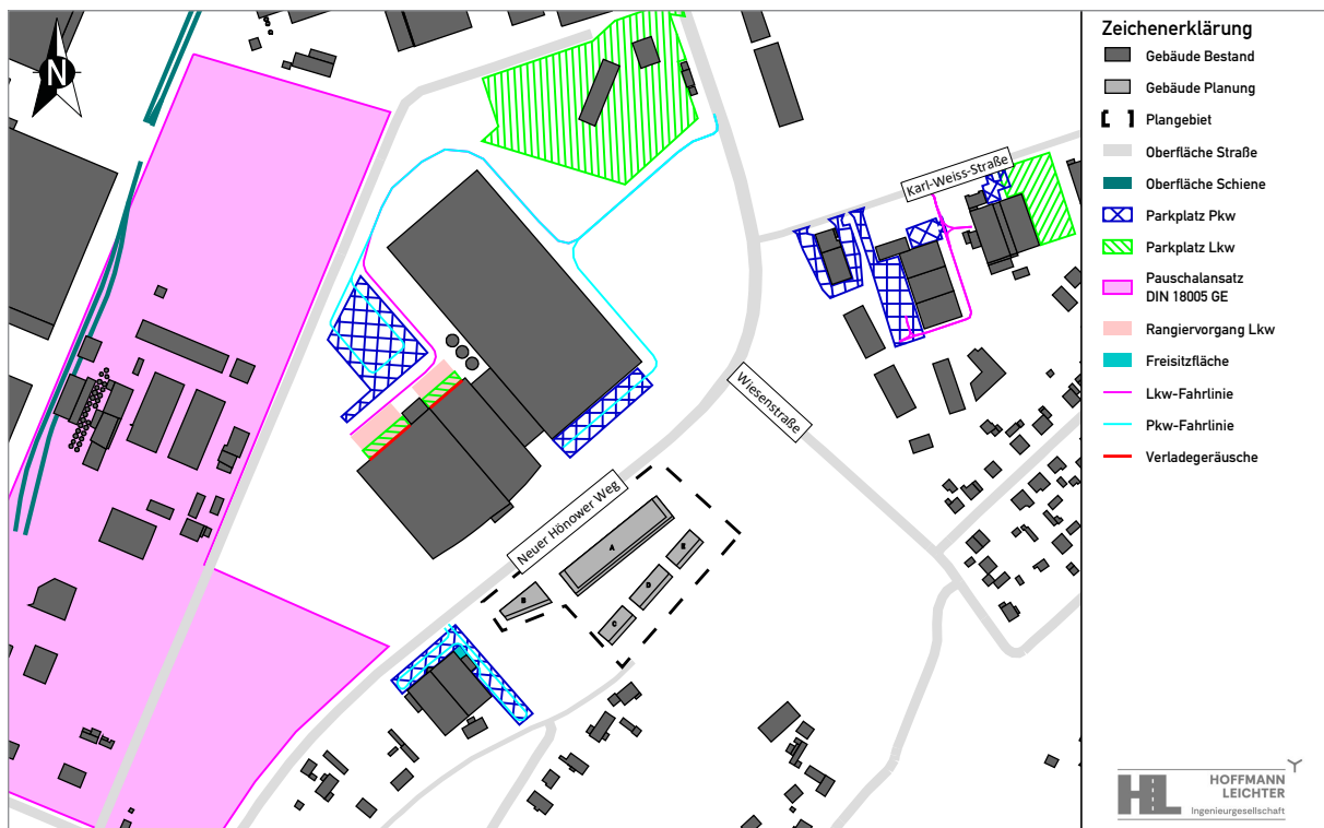
Abbildung 4-1 Lage der Schallquellen zum Anlagenlärm
